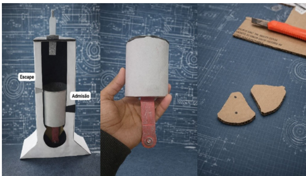
Figura 1A. Etapas da construção da maquete didática do motor de 2 tempos, evidenciando a confecção do pistão, do cilindro e dos componentes estruturais utilizados na montagem
