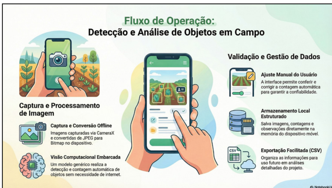
Figura 2 . Fluxo de operação do sistema de detecção e análise de objetos em campo
