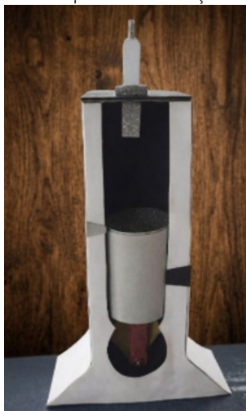
Figura 1B. Maquete didática do motor de dois tempos finalizada, evidenciando a estrutura completa e os componentes utilizados para demonstração do seu funcionamento.
