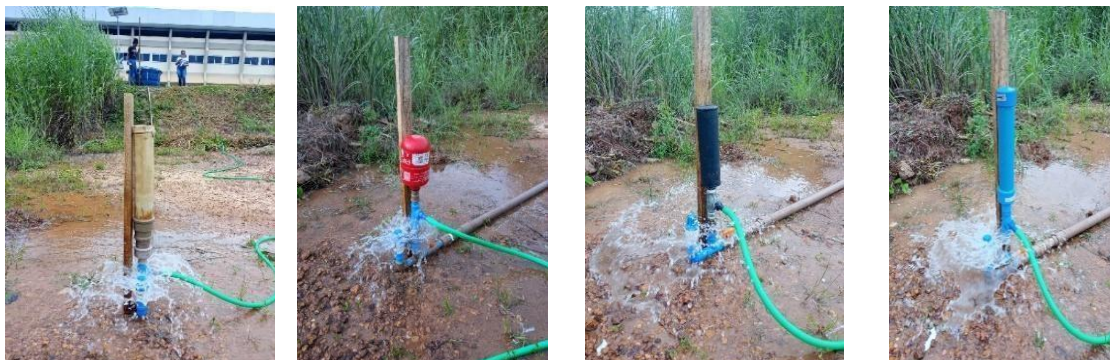
Figura 1 - Carneiros hidráulicos com diferentes campânulas representando os tratamentos.
